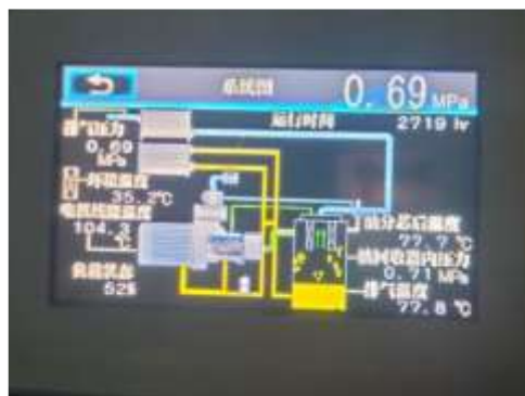
節能螺桿空氣壓縮機的操作介面
